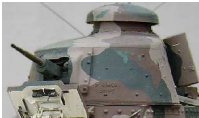
Tourelle avec mitrailleuse de 8 mm
