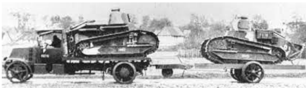
Porte-char : le faible poids du char permet de le transporter facilement
